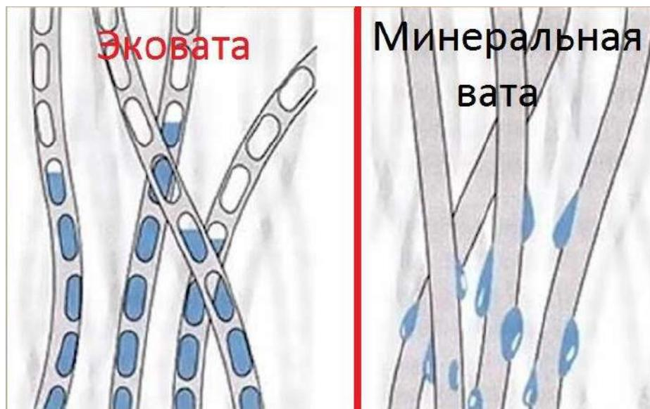
На фото видна структура молекул Эковаты и минеральной ваты. Это довольно сложное явление и оно порождает большие споры в части использования пароизоляции при утеплении эковатой. Сторонники того что пароизоляция не нужна, как раз и имеют ввиду вот этот дополнительный механизм влагопереноса, который работает в обратную сторону и эковата имеет возможность высыхать не только снаружи, но и внутри.
