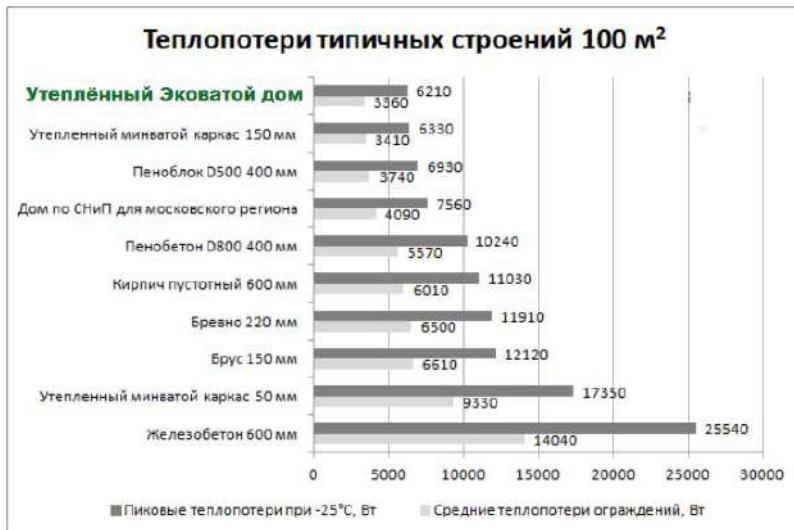
Для анализа возьмем простое, одноэтажное здание 10 x 10 метров, с покатой крышей и толщиной стен 150 мм, которое утеплено эковатой. Самые большие теплопотери в данном случае рассчитаны на температуру внешней среды — 25 градусов по Цельсию.
